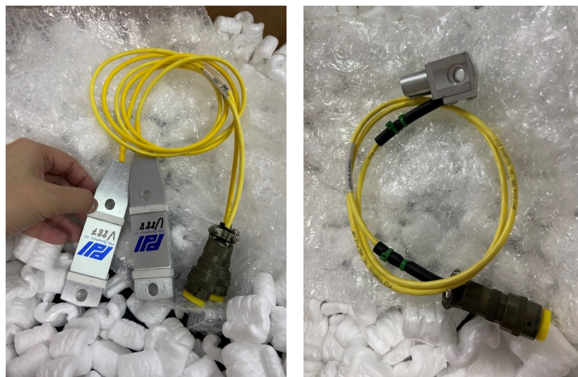
รูปที่ 21 แสดงอุปกรณ์ Strain Transducers และ Accelerometers
